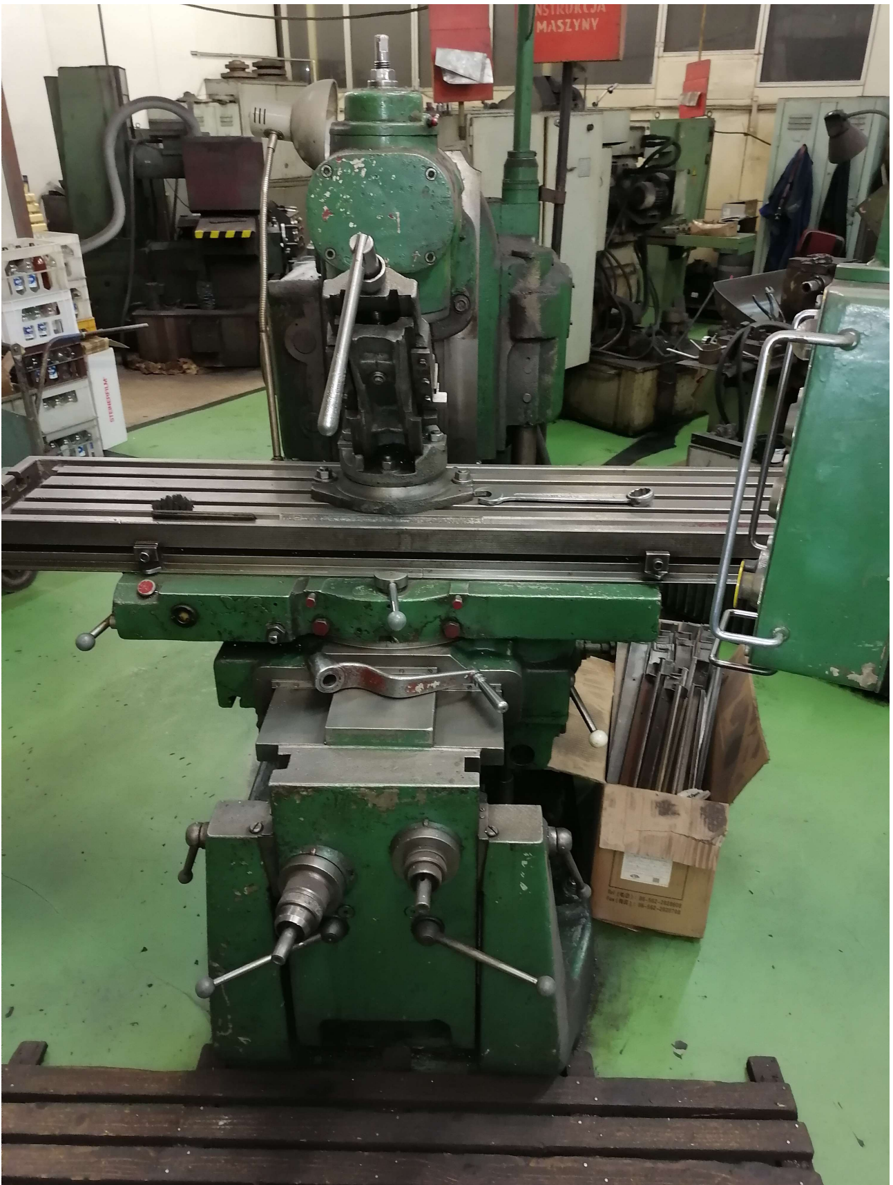
Frezarka wspornikowa FWA-32M Rok budowy 1974 Polska
